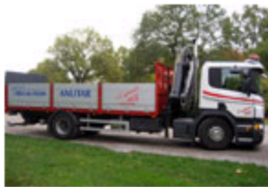
Kranbilar med redskap anpassade för byggverksamheter.
