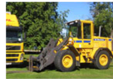
Lastmaskiner med gafflar, skopa, snöblad och bom.
